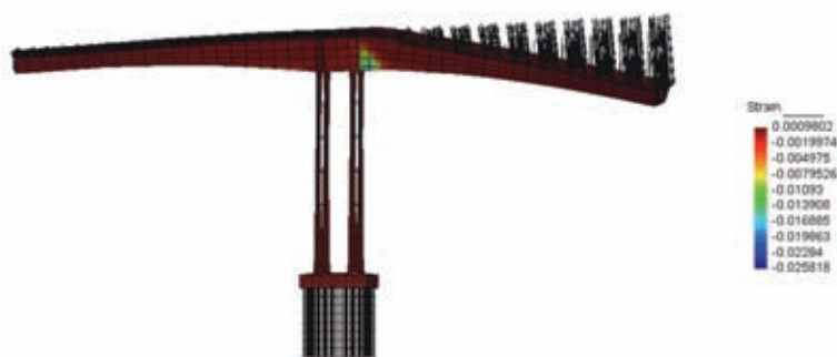
Obr. 12 – Most při kolapsu: deformovaný tvar a plastická přetvoření betonu v tlaku
