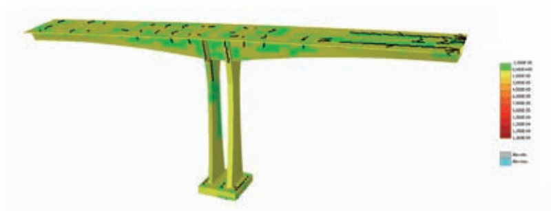
Obr. 11 – Šířky trhlin při návrhovém zatížení
