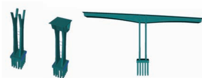
Obr. 9 – Postup výstavby: pilíř, zárodek mostního nosníku, celý most
