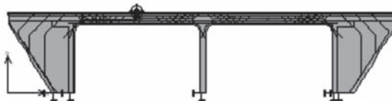
Obr. 3 – Vyztužení uvažované ve výpočtu
