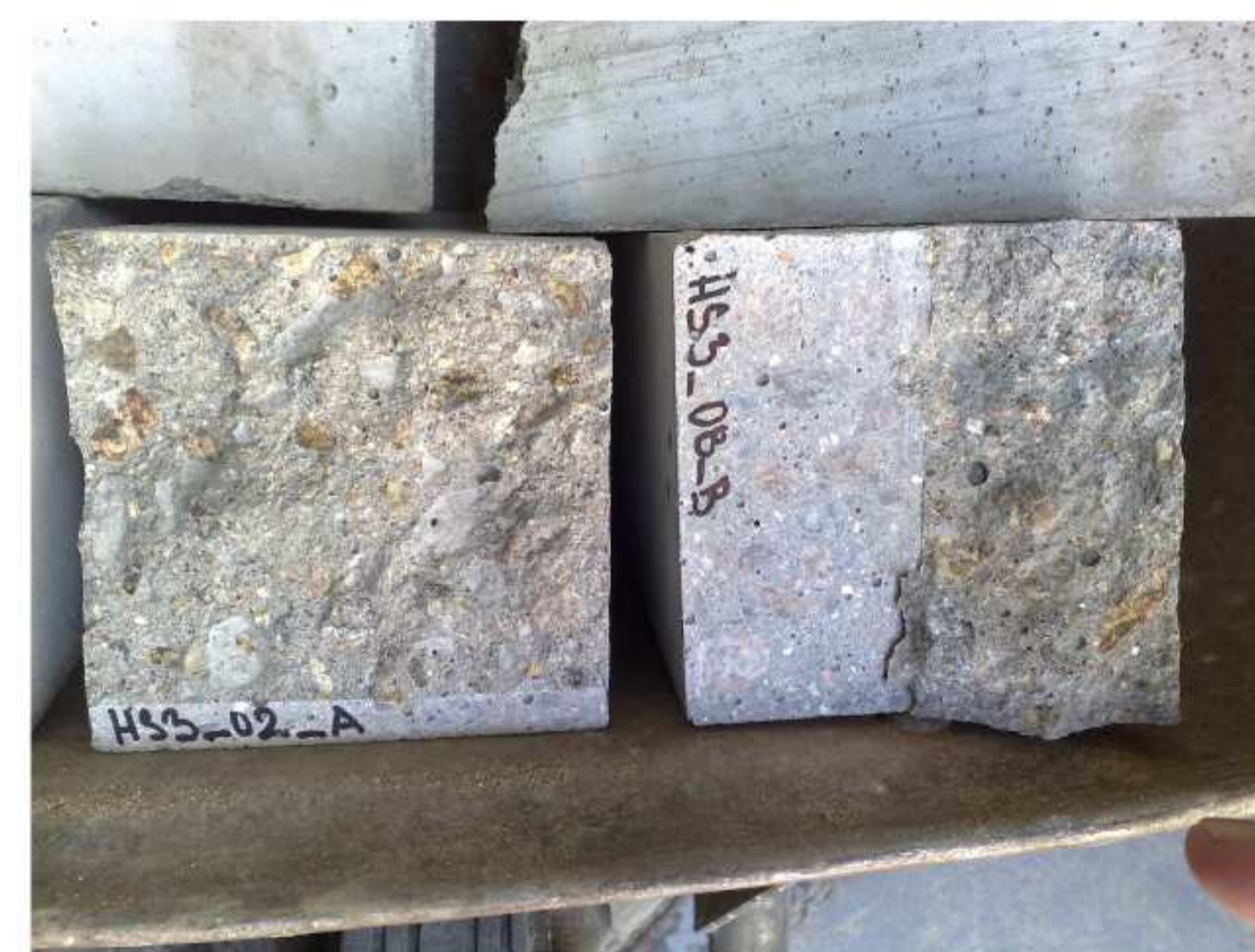
Porušený vzorek na konci testu
